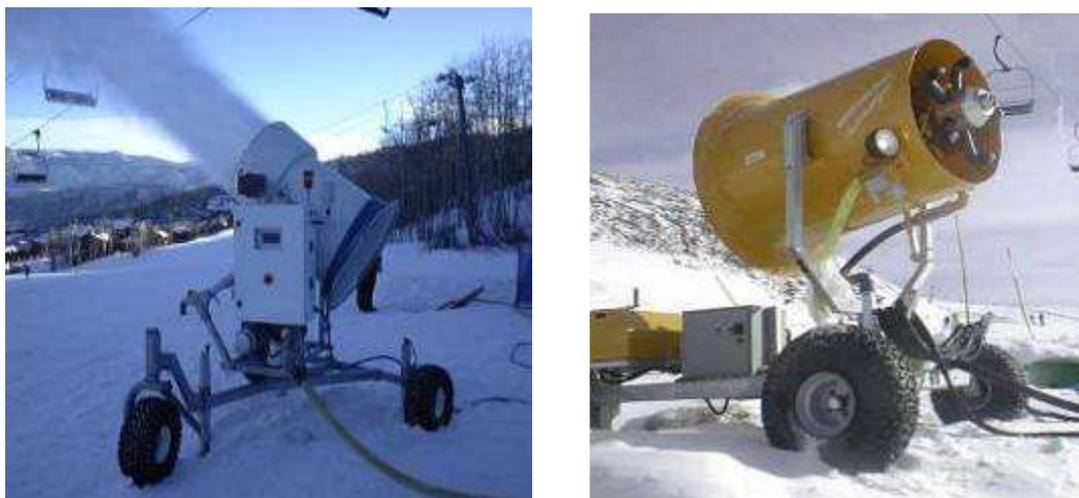
**Figure D : photographies d'un enneigeur multigicleur (à gauche) et de l'enneigeur monobuse (à droite) (<http://www.anpnc.com/>)**
