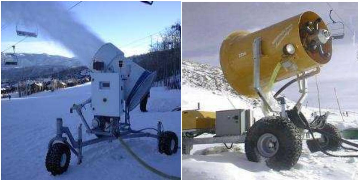
Figure 1 : Photographies d'enneigeurs monofluides basse pression
