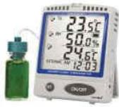
Pendant la durée de l'étude, la température de la pièce ainsi que la température dans l'armoire de stockage (sonde flacon) sont relevées automatiquement avec une fréquence programmée de 4 par heure. Le taux d'humidité ambiante suit la même fréquence de relevés.
